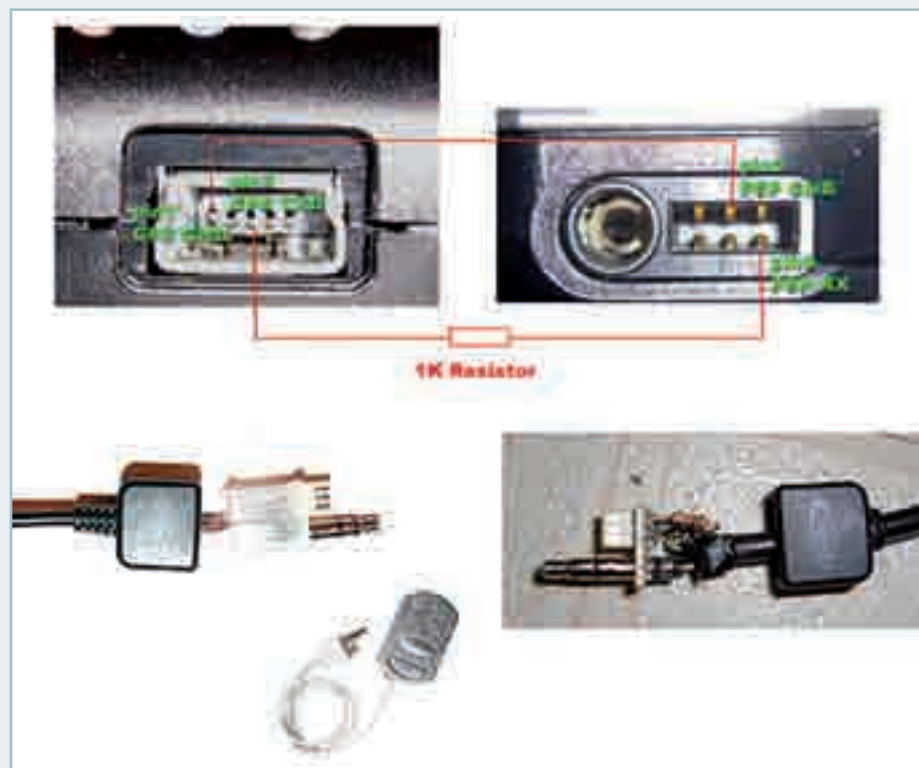
▲ Le modifiche hardware da apportare al cavo della PSP per usarla come GPS.
